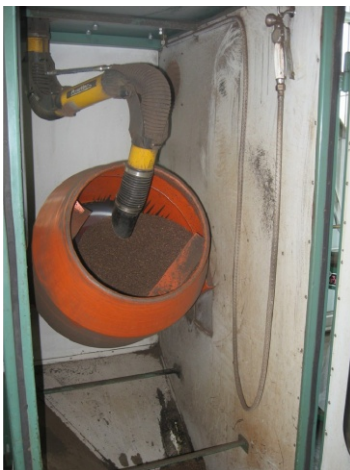
Рис. 1.9. Обескрыливание семян хвойных пород «влажным способом»
