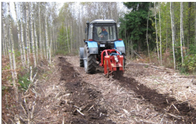
Рис. 3.6. Обработка почвы полосами фрезой ФС-045
