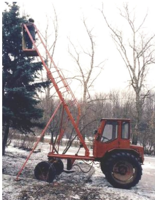
Рис 1.6. Подъемник для сбора шишек и плодов с растущих деревьев
