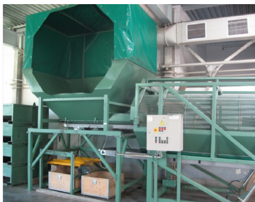
Рис 1.8. Оборудование для извлечения семян из шишек
